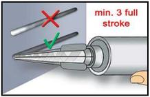
2. Der Mörtelvorlauf darf nicht zur Befestigung der Ankerstange verwendet werden. Daher Vorlauf solange verwerfen, bis sich eine gleichmäßig graue Mischfarbe eingestellt hat, jedoch min. 3 volle Hübe. Bei Schlauchfoliengebände sind min. 6 Hübe zu verwerfen.
