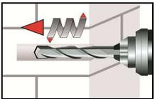
3. Das Bohrloch, senkrecht zur Oberfläche des Verankerungsgrundes, mit Bohrverfahren nach Anhang C4-C39 mit vorgeschriebenem Bohrerinnendurchmesser und Bohrlochtiefe entsprechend der Ankergröße und Einbindetiefe des gewählten Dübels im Verankerungsgrund erstellen. Bei Fehlbohrungen ist das Bohrloch zu vermörteln.
