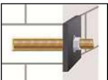
9. Nach vollständiger Aushärtung kann das Bauteil mit bis zu dem maximalen Installationsdrehmoment (siehe Anhang C4-C39) montiert werden. Die Mutter muss mit einem kalibrierten Drehmomentschlüssel angezogen werden.
