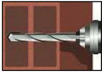
3. Das Bohrloch, senkrecht zur Oberfläche des Verankerungsgrundes, mit Bohrverfahren nach Anhang C4-C39 mit vorgeschriebenem Bohrerinnendurchmesser und Bohrlochtiefe entsprechend der Ankergröße und Einbindetiefe des gewählten Dübels im Verankerungsgrund erstellen. Bei Fehlbohrungen ist das Bohrloch zu vermörteln.
