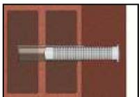
5. Die Siebhülse bündig mit der Oberfläche des Verankerungsgrundes in das Bohrloch einstecken. Sicherstellen, dass die Siebhülse optimal ins Bohrloch passt. Siebhülse niemals kürzen, außer SH 16x130/330. Für Installation der SH 16x130/330 Siebhüslänge bestimmen und von der Spitze her auf die gewünschte Länge abschneiden und Kappe aufsetzen. Nur Siebhülsen mit richtiger Länge verwenden.
