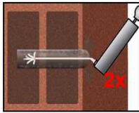
4. Bohrloch vom Bohrlochgrund her zweimal ausblasen. Die Stahlbürste mit passender Größe ( $> d_{b,min}$  Tabelle B2 oder B3) in eine Bohrmaschine oder einen Akkuschauber einstecken, das Bohrloch zweimal ausbürsten und abschließend erneut zweimal ausblasen.
