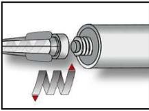
1. Den mitgelieferten Statikmischer fest auf die Kartusche aufschrauben und Kartusche in eine geeignete Auspresspistole einlegen. Bei Schlauchfolienkartuschen den Clip vor der Verwendung abschneiden.
