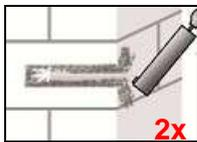
4. Bohrloch vom Bohrlochgrund her zweimal ausblasen. Die Stahlbürste mit passender Größe ( $> d_{b,min}$  Tabelle B2 oder B3) in eine Bohrmaschine oder einen Akkuschrauber einstecken, das Bohrloch zweimal ausbürsten und abschließend erneut zweimal ausblasen.
