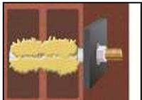
9. Nach vollständiger Aushärtung kann das Anbauteil mit bis zu dem maximalen Installationsdrehmoment (siehe Anhang C4-C39) montiert werden. Die Mutter muss mit einem kalibrierten Drehmomentschlüssel angezogen werden.
