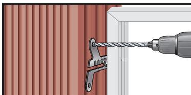
Löcher mit  $\varnothing 10$  mm bohren.
