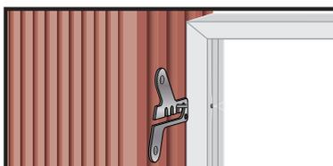
Die Montage mit ProtectFIX ist fertig und der Befestigungspunkt ist gesichert.
