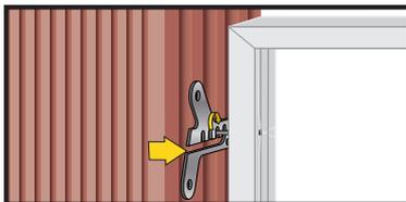
ProtectFIX Lasche von innen oder außen an der Fensterbauschraube FBS/FBS-Z einhängen. Die Schraube in eine der vier Aufnahmen positionieren und die Lasche waagrecht ausrichten.
