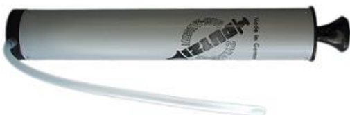
Handpumpe (Volumen 750 ml) Bohrernennendurchmesser ( d_0 ): 10 mm bis 20 mm oder Setztiefe bis 240 mm
